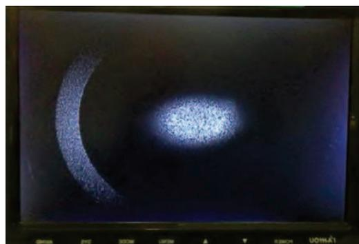
図 6.1.5: 白黒アナログカメラで撮影したレーザーモニター画面。中央の楕円が YAG レーザースポットを表す散乱光、左端の半月状の構造はミラーホルダー上の散乱光を表す。
